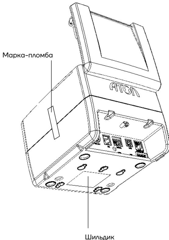
Рисунок 1. Расположение маркировки на корпусе ККТ
