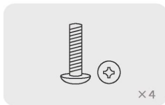
Четыре крепежных винта М8 (М6)
