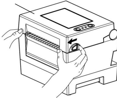
2) Insert Fan-Fold Paper to Fan-Fold.
