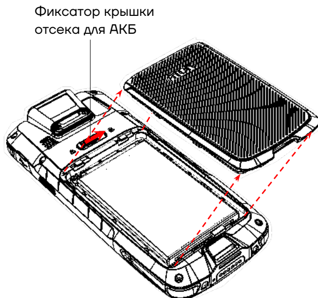
Рисунок 5. Отделение крышки отсека для АКБ от корпуса
