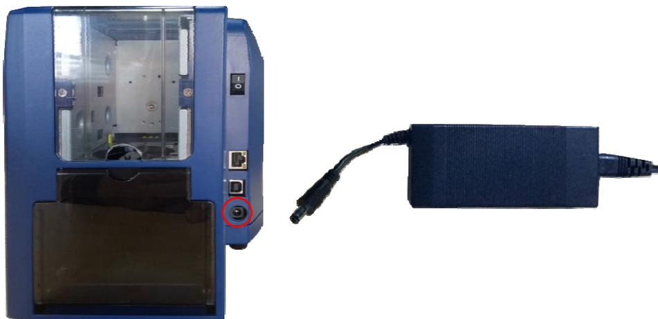
Убедитесь, что блок питания не имеет повреждений корпуса и подключение имеет заземление.
