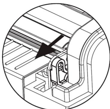
Рычаг поднят: ролик отделителя заблокирован.
