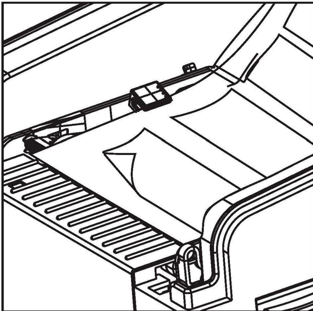
4) Поднимите рычаг отделителя, и ролик прижмет бумажную подложку. Закройте верхнюю крышку.
