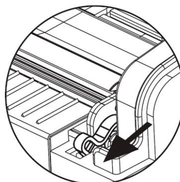
Рычаг опущен: ролик отделителя разблокирован.
