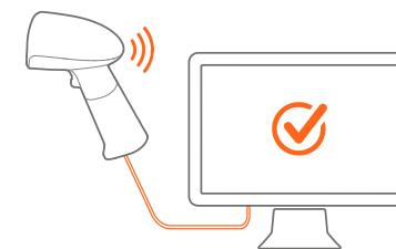
При успешном сканировании прозвучит сигнал, индикатор погаснет, затем сканер передаст сообщение со штрих-кодом в систему.
