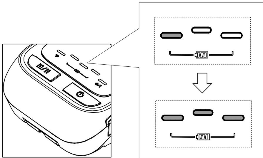
Turn on the Power/開啟電源/开启电源/電源を入れる/Включение принтера/Schalte den Strom an/Allumer l'appareil/Conectar la alimentación/Accendi il potere/ تشغيل الطاقة
