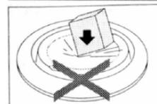
§ Соблюдайте осторожность при взвешивании предметов с электростатическим зарядом (пластики, изоляторы и пр.). Постарайтесь поддерживать относительную влажность воздуха не ниже 45 % или используйте металлический экран.
