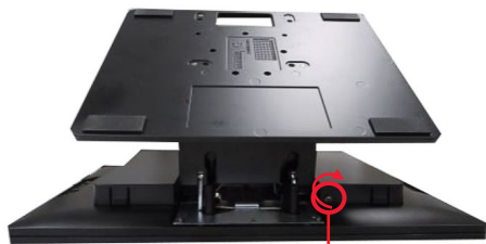
Винт для крепления задней крышки огнестойкой системы
