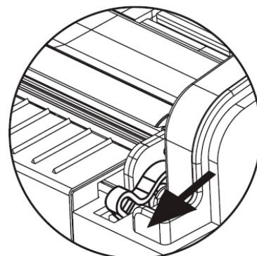
Рычаг опущен: ролик отделителя разблокирован.
