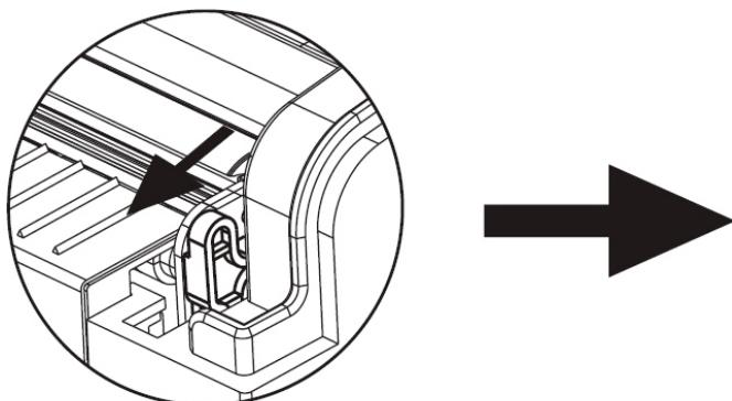
Рычаг поднят: ролик отделителя заблокирован.
