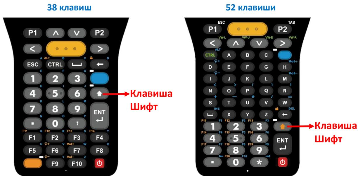
При двойном нажатии **Клавиши Шифт**, клавиатура перейдет в **Режим "Shift Lock"** (**Заблокированный Шифт-Режим**) и в строке состояния появится иконка
