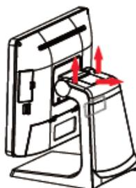
Рисунок 15. Снятие крышки крепления второго монитора
