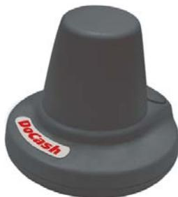
Подключив к прибору видеолупу **DoCash VL**, Вы получаете возможность просматривать изображения на экране прибора с увеличением  $\times 20$  в видимом спектре, в ИК и УФ спектре. Для включения видеолупы нажмите кнопку на видеолупе. Последовательное нажатие кнопки на видеолупе переключает режим подсветки видеолупы. **DoCash VL** позволяет исследовать специфику печати и элементы микропечати, обнаружить попытки внесения изменений методами подчистки, наклейки и др.
