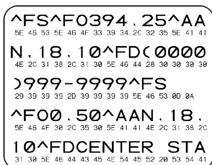
Рис. 9 Образец этикетки режима диагностики обмена данными
