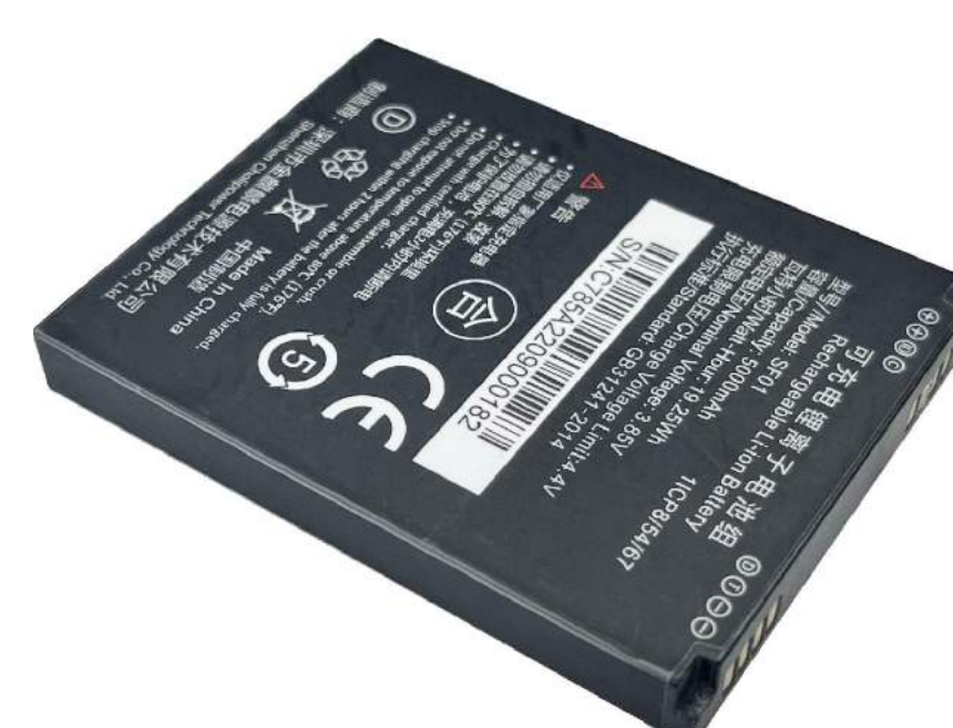
Аккумулятор P/N: CHA-BTRY-T3 Pro-5000MA 5000 мАч, 3.85 В.
