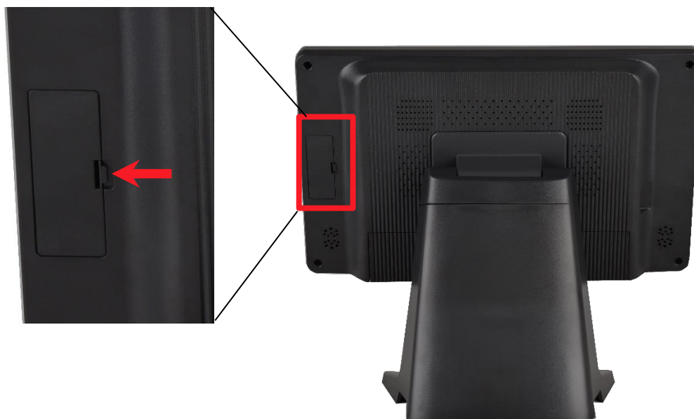
Рисунок 7. Направление приложения усилий на фиксатор для открытия крышки отсека с кабелем для подключения считывателя магнитных карт
