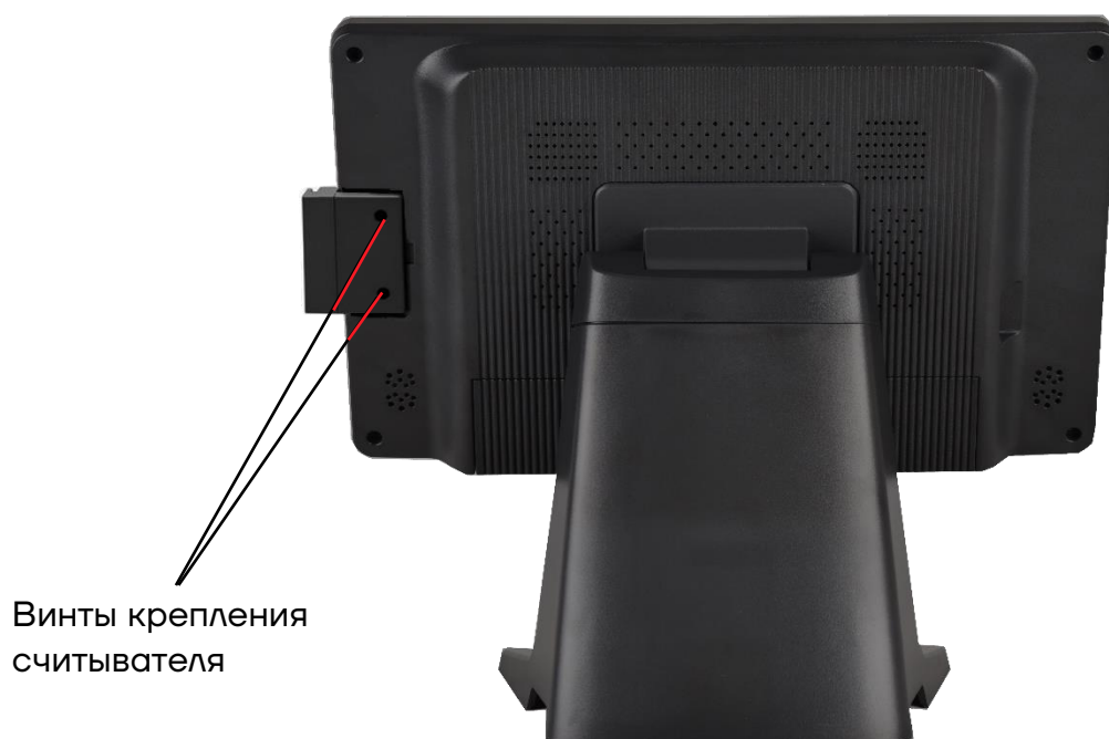
Рисунок 9. Считыватель магнитных карт установлен на корпус POS-терминала
