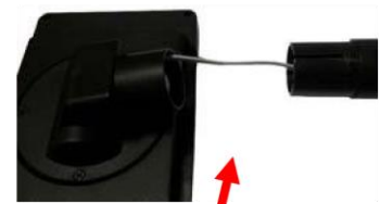
Протяните кабель через первую трубку
