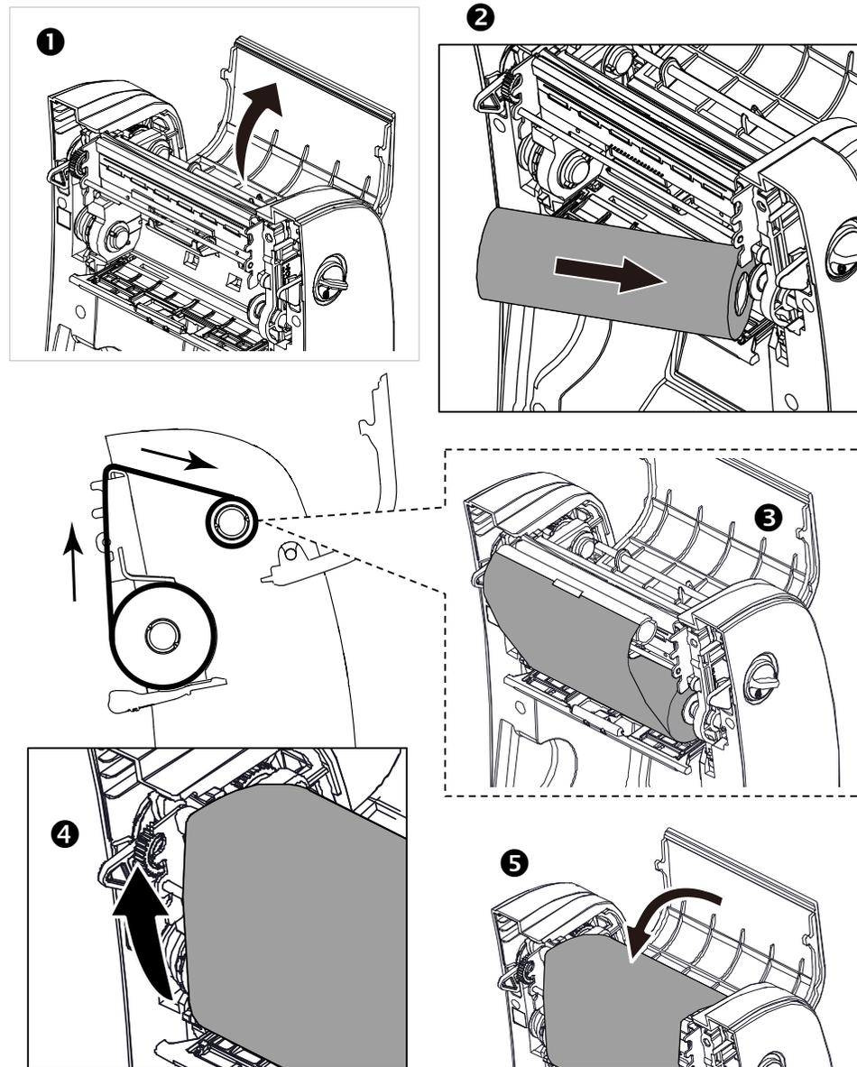
Loading Media/安裝標籤/安裝标签/メディアの読み込み/Загрузка носителя/Medien werden geladen/Chargement des medias/Cargando medios/Caricamento dei media/تحميل الوسائط
