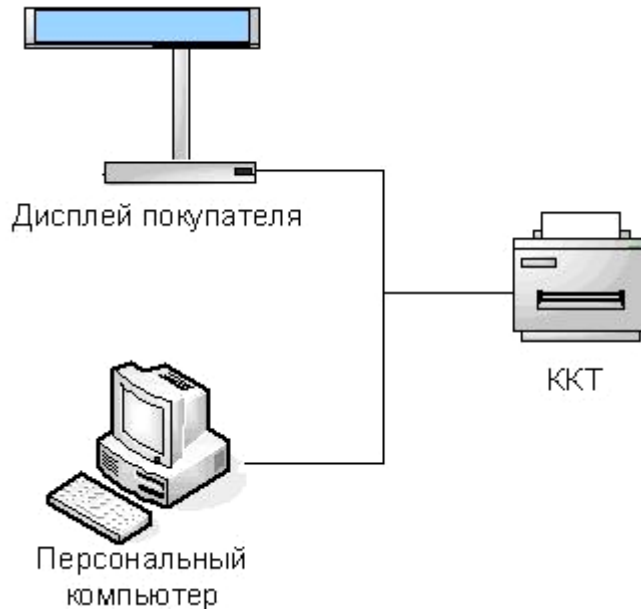
Рисунок 5. Подключение управляющих устройств к ККТ
