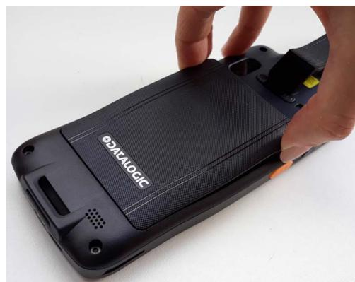
2. Сперва вставьте аккумуляторный блок в отсек, верхней частью вперед, а затем защелкните его.
