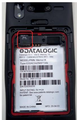
4. Установите обратно аккумулятор и крышку аккумуляторного отсека (см. «Установка аккумуляторной батареи» на стр. 7, шаги 3 и 4).
